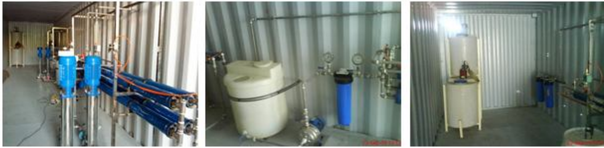
شکل ۵ سیستم تصفیه آبدر مقیاس کوچک و قابل حمل ساخت شرکت آبنیک
