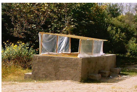
{شکل شماره ۲-نمایی از پایلوت ساخته شده بستر لجن خشک کن ماسه ای}
